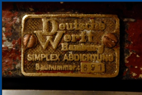
Het plaatje op de schroefasafdichting vermeldt 'Deutsche Werft Hamburg Simplex Abdichtung Baunummer 691' - sinds 1927 product van Technisch Bureau Uittenboogaard
