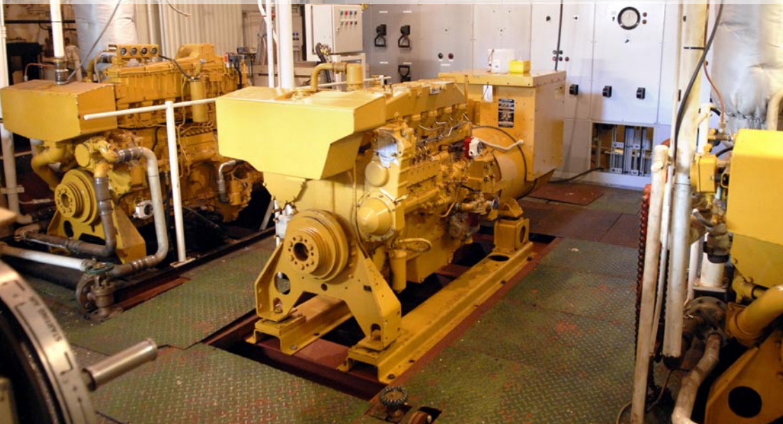
Drie generatoren op rij, allen Caterpillar van het type 3406
